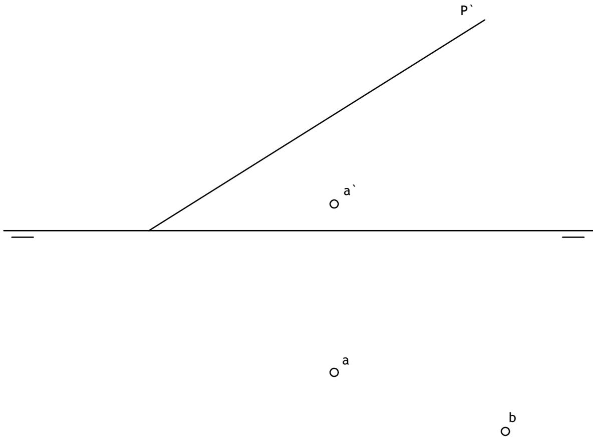
Dadas la traza vertical  $P'$  de un plano  $P$ , las proyecciones  $a'$  del punto  $A$  y la proyección horizontal del punto  $B$  contenidos ambos en el plano  $P$ , se pide:
