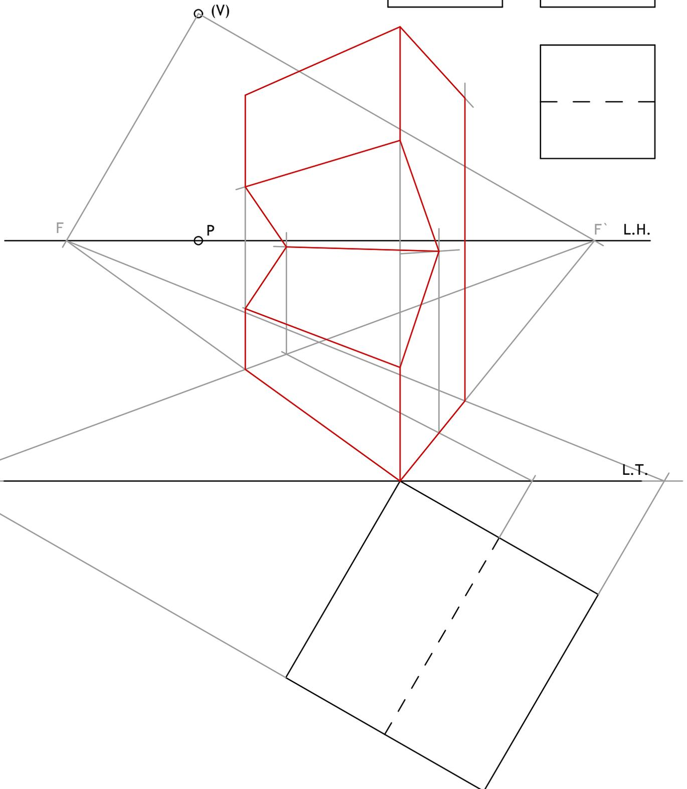
Definido el sistema cónico por la línea de tierra L.T., la línea de horizonte L.H., el punto principal P y el abatimiento sobre el plano del cuadro del punto de vista (V), se pide:
