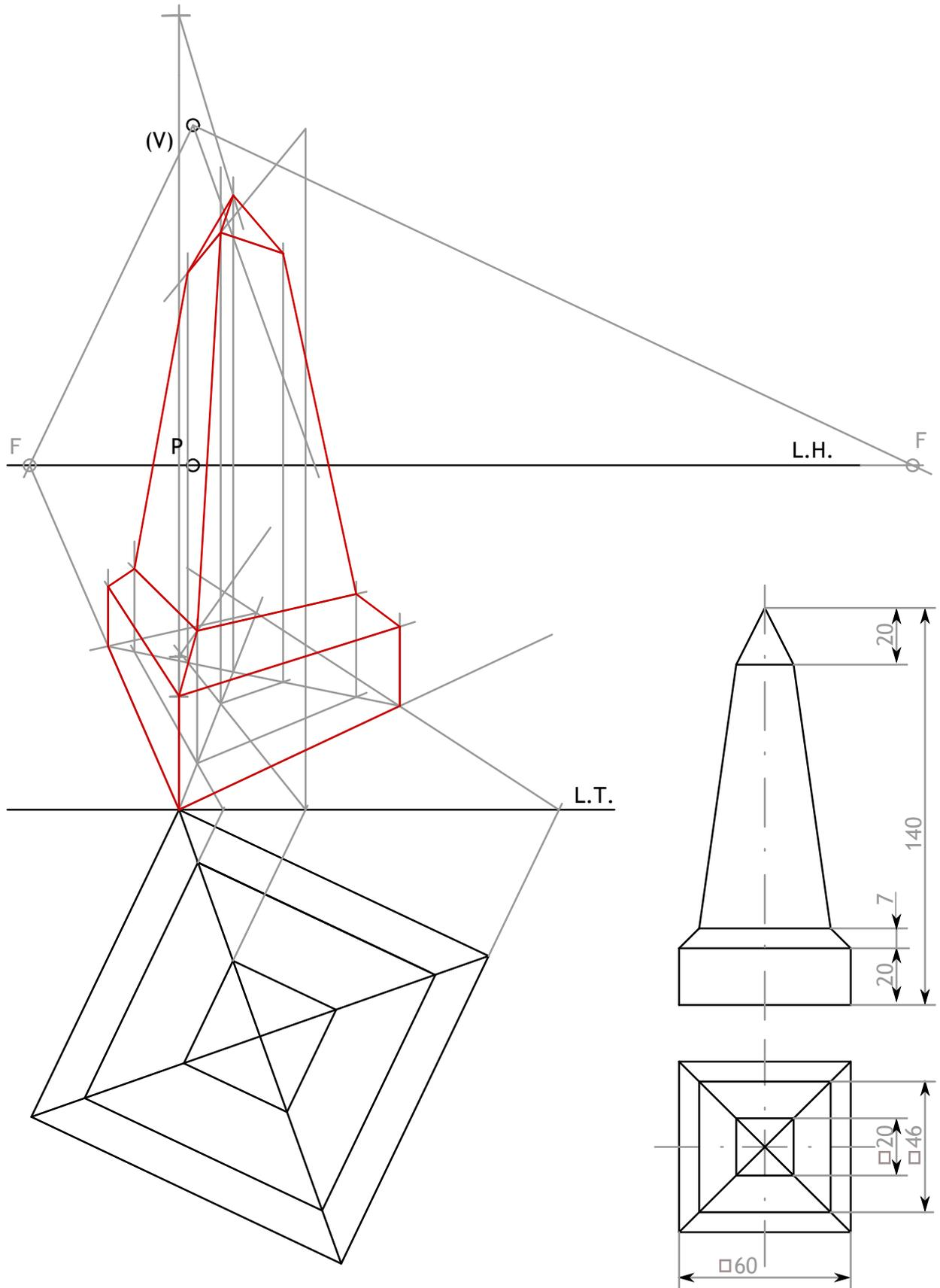
Definido el sistema cónico por la línea de tierra L.T., la línea de horizonte L.H., el punto principal P y el abatimiento sobre el plano del cuadro del punto de vista (V), se pide: i
