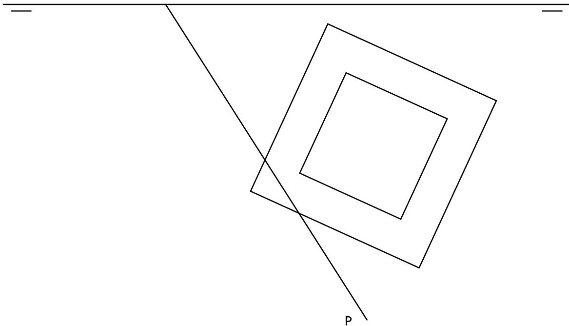
Dadas la proyección horizontal de un tubo cuadrangular apoyado en el plano horizontal de proyección y la traza horizontal de un plano P que forma  $45^\circ$  con el plano horizontal de proyección, se pide:
