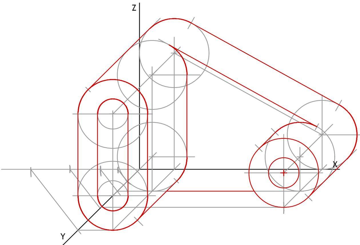
Dibujar a escala 4:3 la perspectiva caballera de la pieza definida por su alzado y perfil izquierdo a escala 1:1 según el método del primer diedro, sabiendo que el coeficiente de reducción es 1/2.
