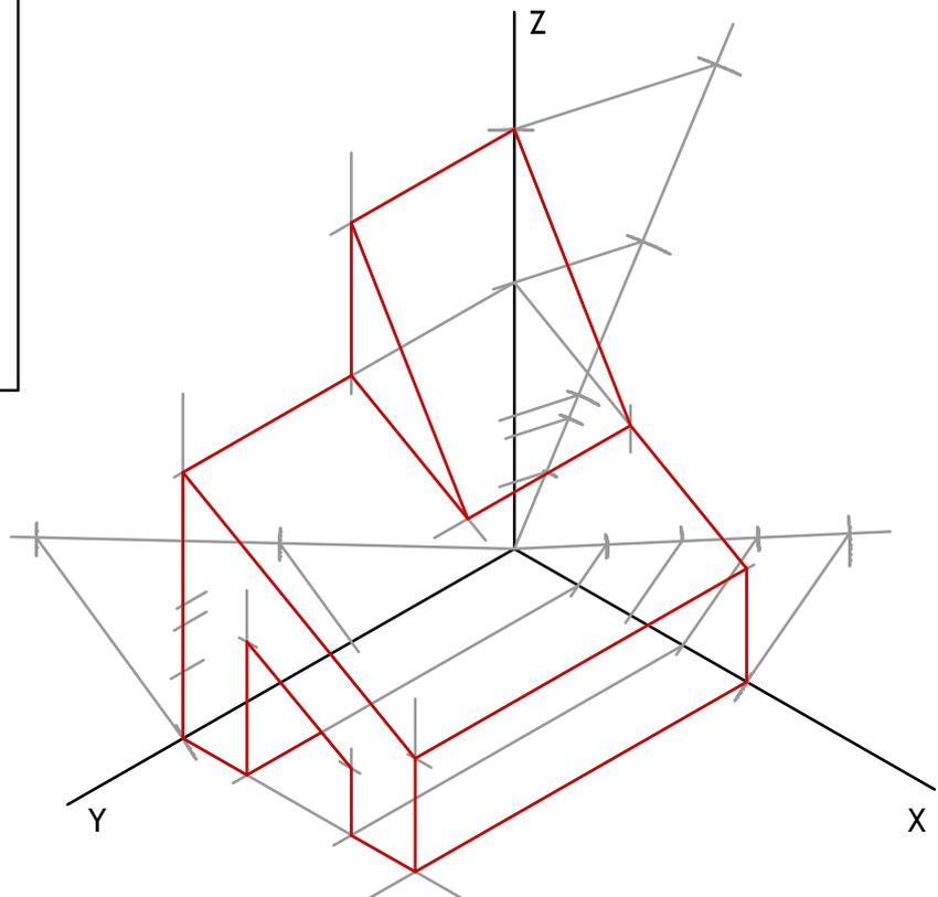
Dibujar la perspectiva isométrica a escala 1:1 de la figura representada en el Sistema Europeo (primer diedro) por sus vistas:
