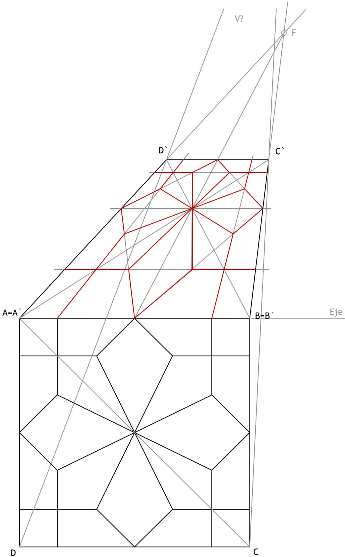
De una homología afín en el plano del dibujo, se conocen: Los puntos A y B y sus afines A'B' y el punto  $1=1'$  del eje de dicha afinidad.
