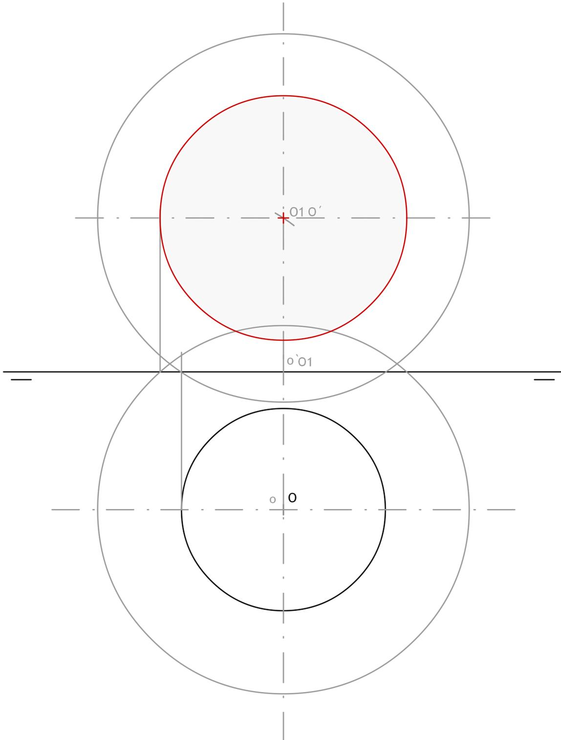
Un cono de revolución de 7 cm de altura tiene por base un círculo, situado en el plano horizontal de proyección, de centro el punto O (o' o) y radio 4 cm.
