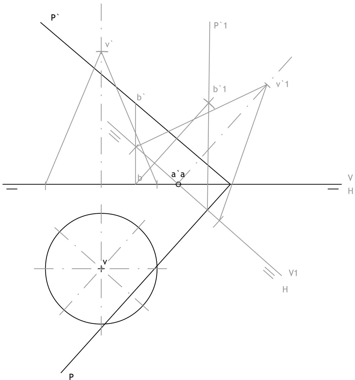
Se conocen las proyecciones horizontal y vertical de un sólido. Obtener la nueva proyección vertical del sólido, mediante un cambio de plano vertical. Se indicarán partes vistas y ocultas del sólido, en la nueva proyección.
