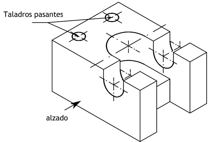
Dada la perspectiva isométrica de una pieza a escala 1:4, se pide:
