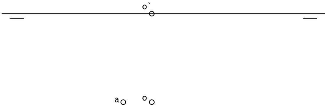
Un cono de revolución de 6 cm de altura tiene por base un círculo, situado en el plano horizontal de proyección, de centro el punto O ( $o'o$ ) y radio 4 cm.
