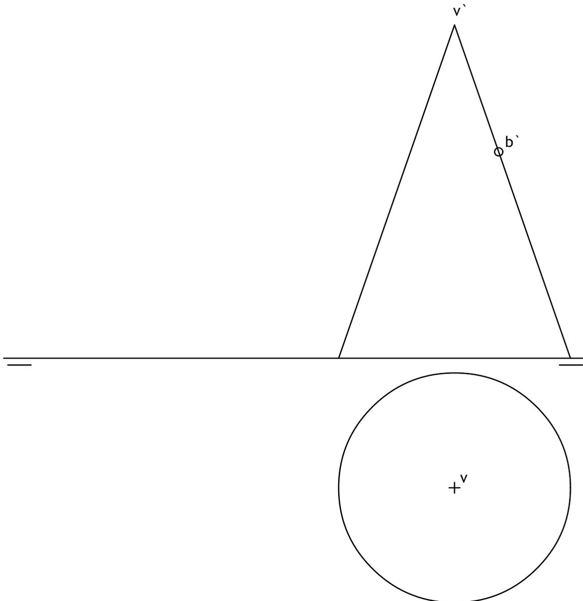
Definidas las proyecciones de un cono de revolución de vértice  $V (v'v)$  y la proyección vertical de un punto  $B (b'b)$  situado en su superficie, se pide:
