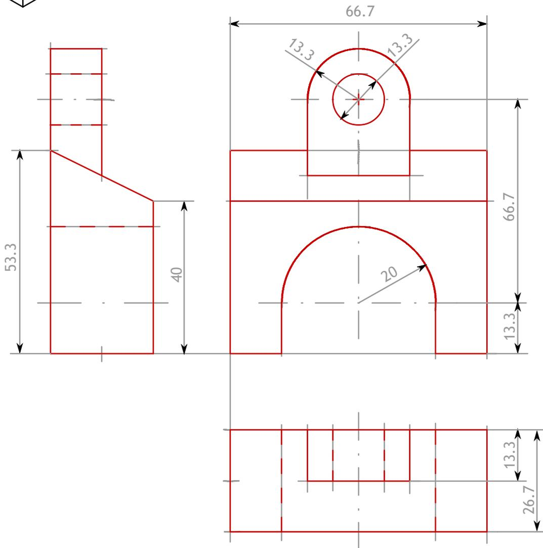
Dado el dibujo isométrico de la figura adjunto a la escala 1:2 (sin la aplicación del coeficiente de reducción), representar en el Sistema Europeo (primer diedro) las vistas de alzado y planta a la escala 1:1. Acotar debidamente normalizadas las vistas solicitadas.
