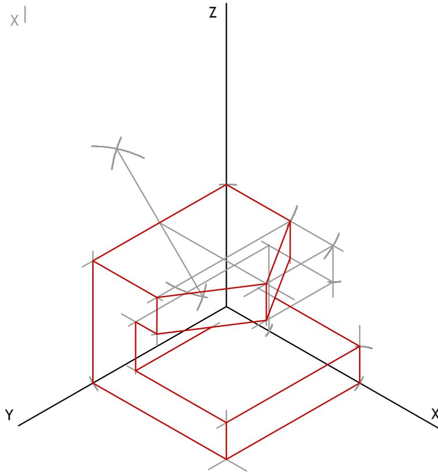
Dibujar y acotar la perspectiva isométrica a escala 1:1 de la figura representada en el Sistema europeo (primer diedro) por sus vistas.
