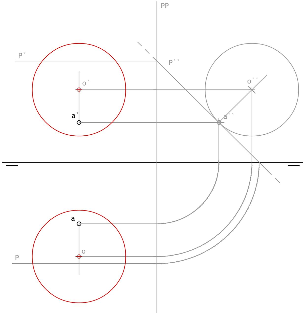
Dada la traza vertical de un plano P, perpendicular al primer bisector, y la proyección vertical del lado AB de la base cuadrangular de un prisma recto de 60 mm de altura, cuya base se encuentra contenida en el plano P y en el primer diedro, se pide:
