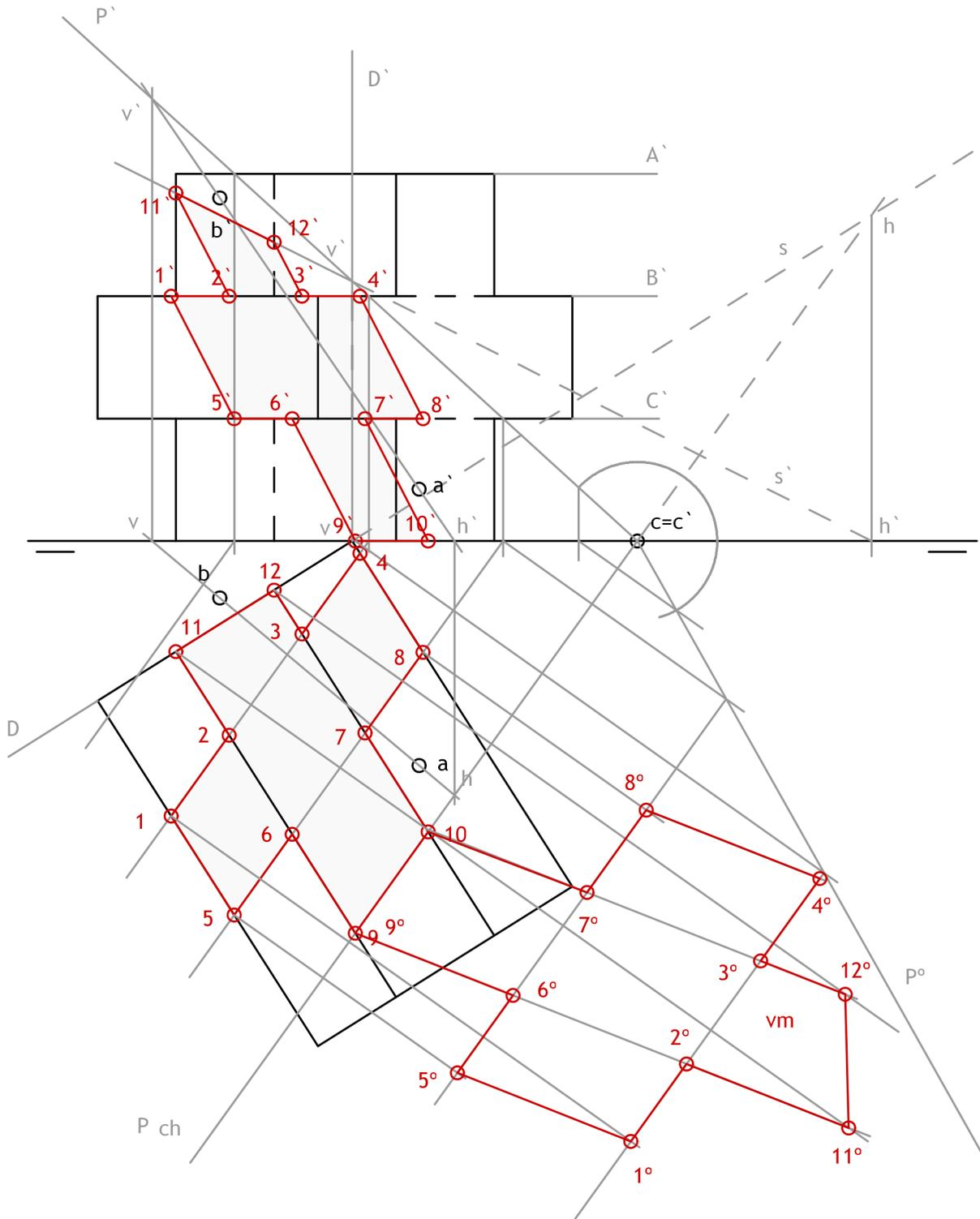
Dadas la proyección horizontal de un tubo cuadrangular apoyado en el plano horizontal de proyección y la traza horizontal de un plano P que forma  $45^\circ$  con el plano horizontal de proyección, se pide:
