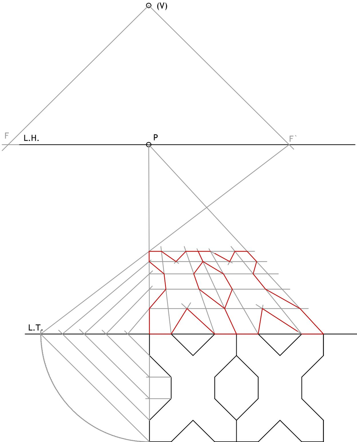
Definido el sistema cónico por la línea de tierra L.T., la línea de horizonte L.H., el punto principal P y el abatimiento sobre el plano del cuadro del punto de vista (V), se pide:
