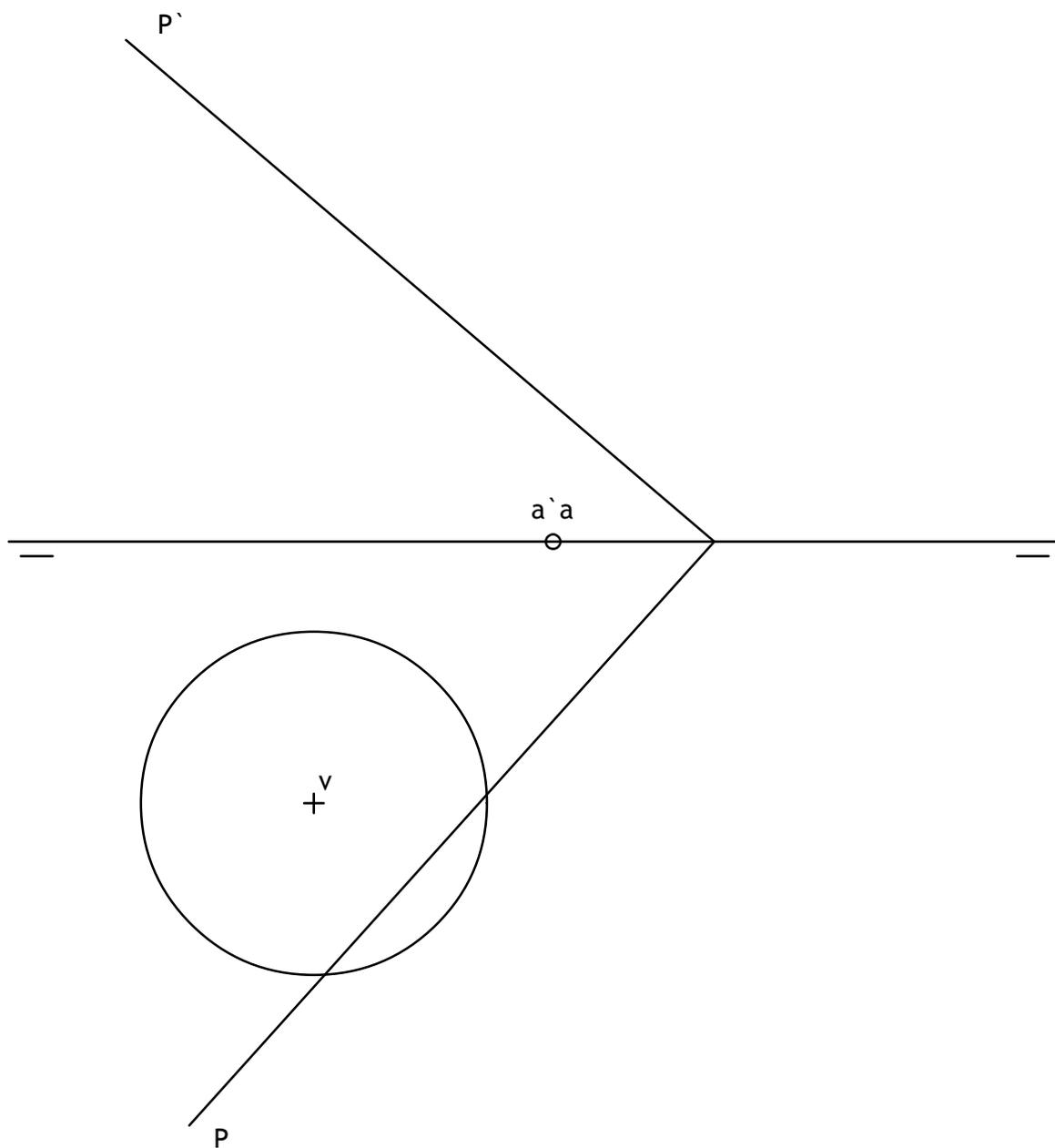
Dado el plano y la proyección horizontal de un cono de revolución apoyado en el plano horizontal de proyección, de 60 mm de altura, se pide:
