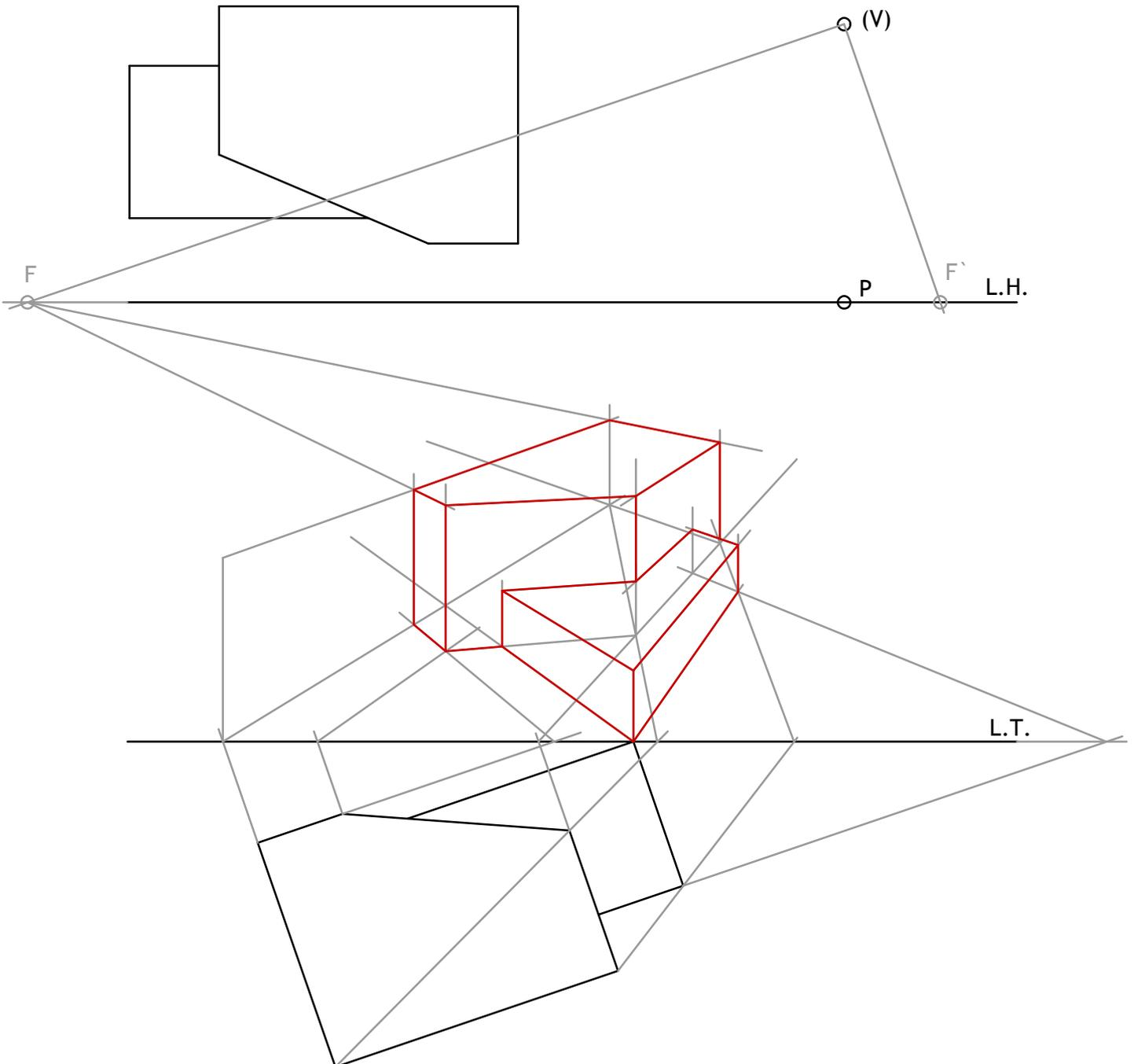
Definido el sistema cónico por la línea de tierra L.T., la línea de horizonte L.H., el punto principal P y el abatimiento sobre el plano del cuadro del punto de vista (V), dibujar la perspectiva cónica a escala 2:1 del sólido dado por sus vistas, según el sistema de representación del primer diedro de proyección a escala 1:1, sabiendo que dicha figura está apoyada en el plano geometral, en la posición indicada en el abatimiento de su planta sobre el plano del cuadro.
