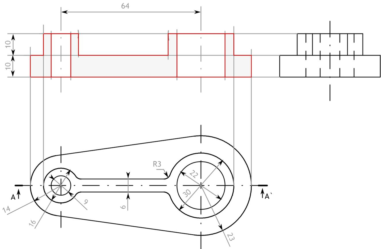
Dadas las vistas de alzado y planta de una pieza, según el método de representación del primer diedro de proyección, a escala 1:4, se pide:
