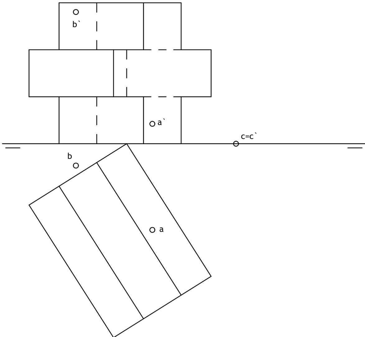
Conocidas las proyecciones de un sólido y las de los puntos A, B y C, se pide:
