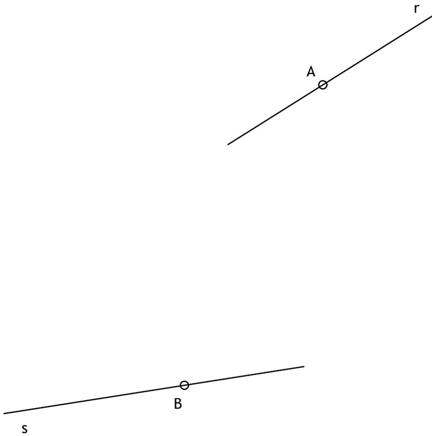
Enlazar las rectas r y s por medio de dos arcos de circunferencia, de curvatura contraria, conociendo los puntos de tangencia sobre ambas rectas, A y B, y el radio del arco tangente en B que es de 22 milímetros.
