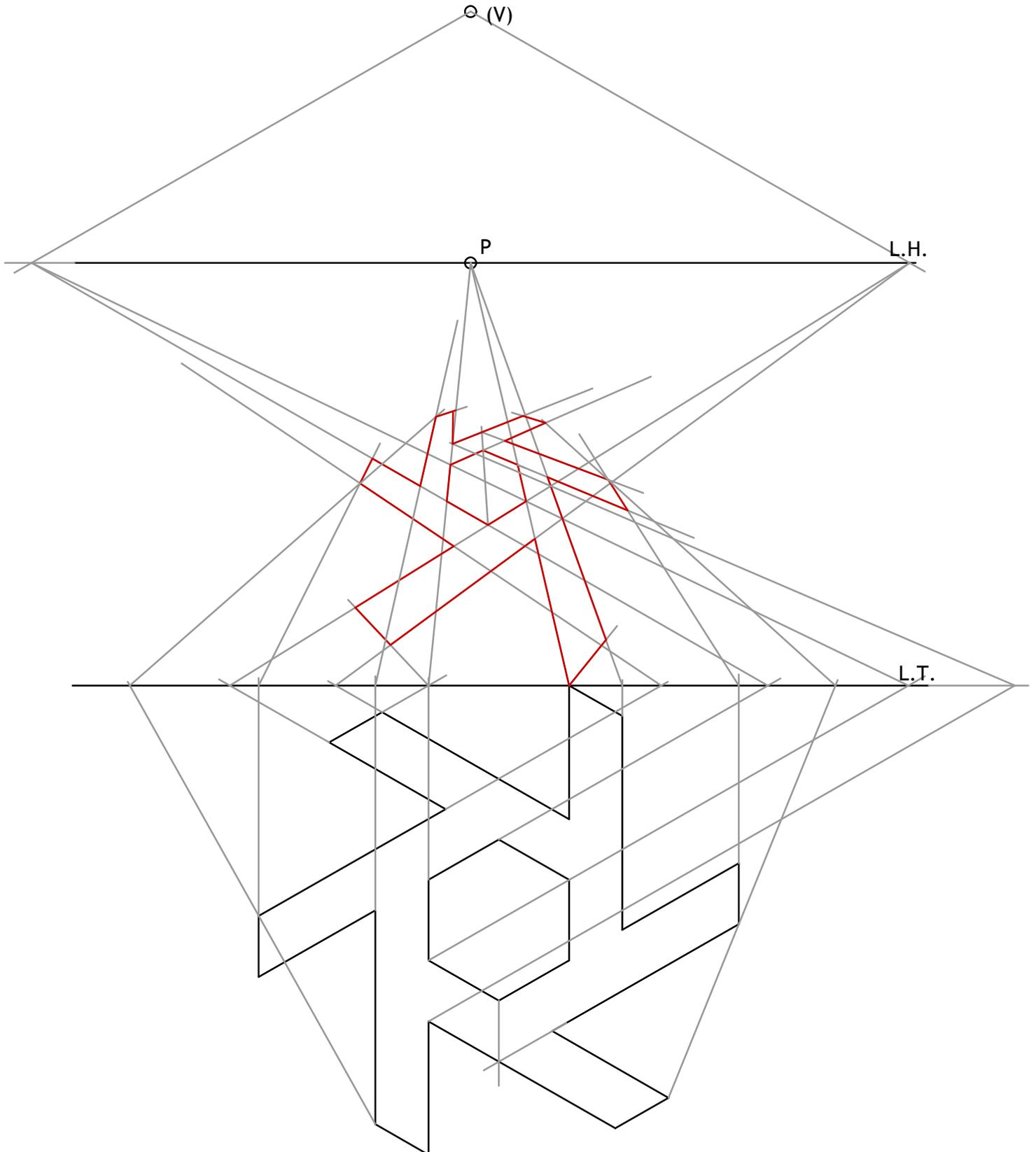
Definido el sistema cónico por la línea de tierra L.T., la línea de horizonte L.H., el punto principal P y el abatimiento sobre el plano del cuadro del punto de vista (V), se pide:
