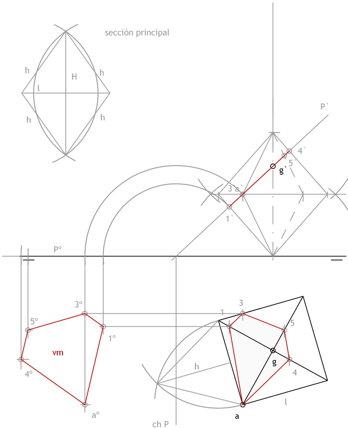
Dada la proyección vertical del triángulo ABC contenido en el plano vertical de proyección y el eje E ( $e' e$ ), se pide:
