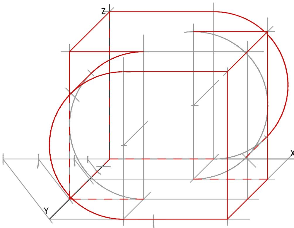
Dados el alzado, la planta y perfil de la pieza de la figura a escala 1:2 por el método del primer diedro, se pide dibujar la perspectiva caballera de la pieza a escala 2:3, aplicando un coeficiente de reducción de 3/4.
