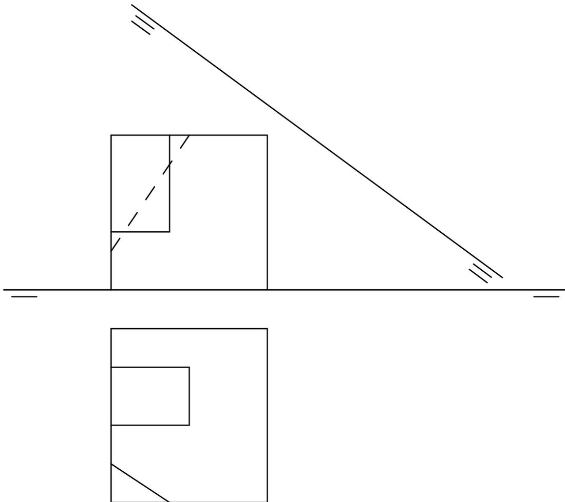
Se conocen las proyecciones horizontal y vertical de un sólido. Obtener la nueva proyección vertical del sólido, mediante un cambio de plano vertical. Se indicarán partes vistas y ocultas del sólido, en la nueva proyección.
