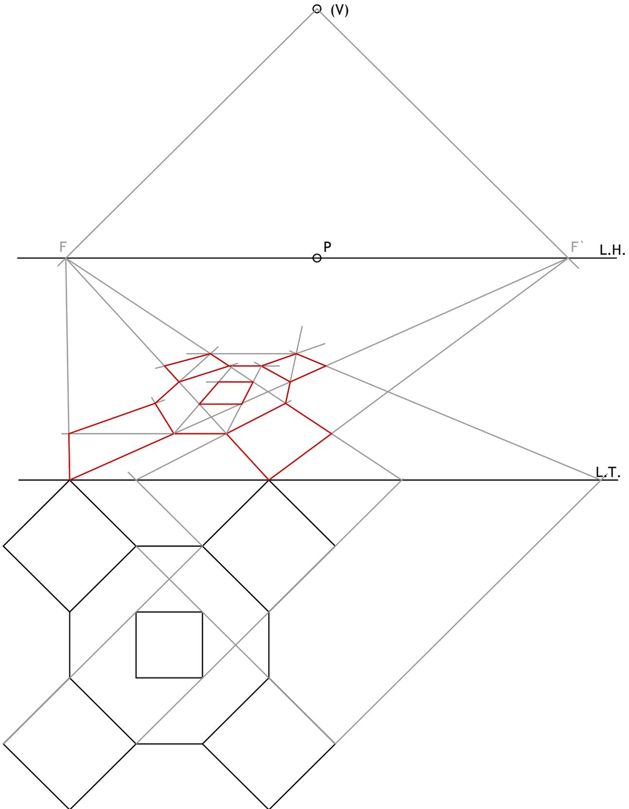
Definido el sistema cónico por la línea de tierra L.T., la línea de horizonte L.H., el punto principal P y el abatimiento sobre el plano del cuadro del punto de vista (V), se pide:
