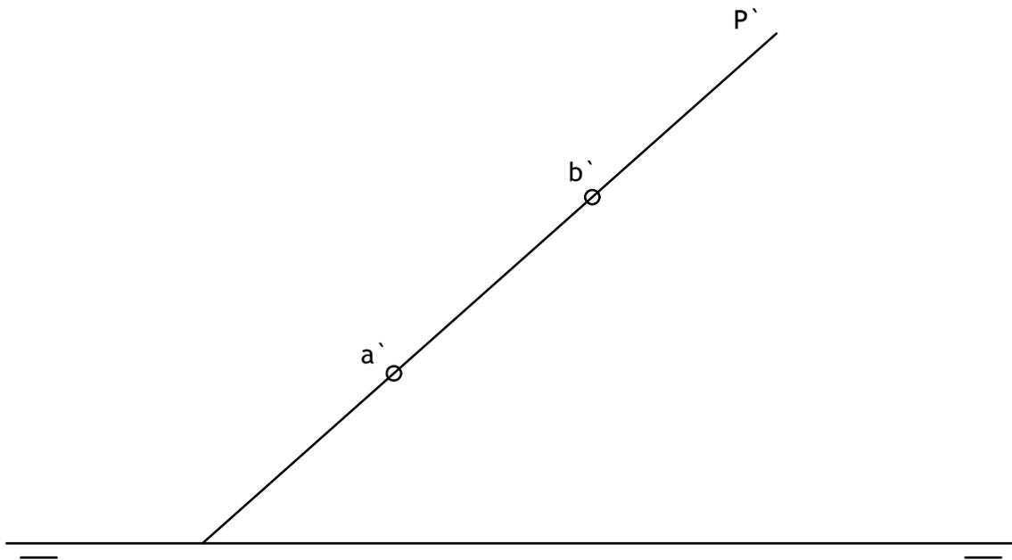
Dada la traza vertical de un plano P, perpendicular al primer bisector, y la proyección vertical del lado AB de la base cuadrangular de un prisma recto de 60 mm de altura, cuya base se encuentra contenida en el plano P y en el primer diedro, se pide:
