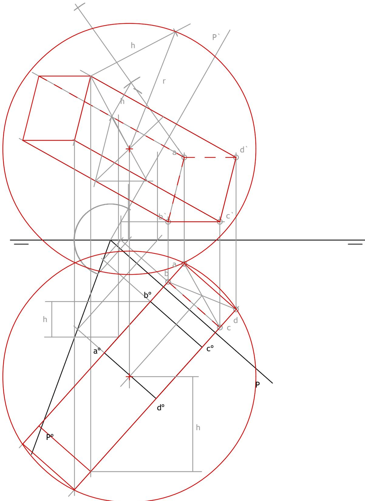
Conocidas las trazas del plano P y la proyección horizontal de un segmento AB contenido en dicho plano, se pide:
