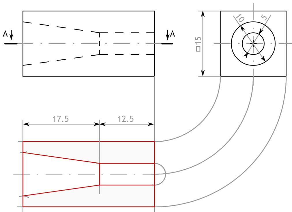
Se dan la planta y la vista lateral izquierda de una pieza industrial en el Sistema Europeo (primer diedro), sabiendo que la escala del dibujo es tal que los 90 mm de altura de la pieza quedan expresados tal como indica la cota dibujada. Se pide:
