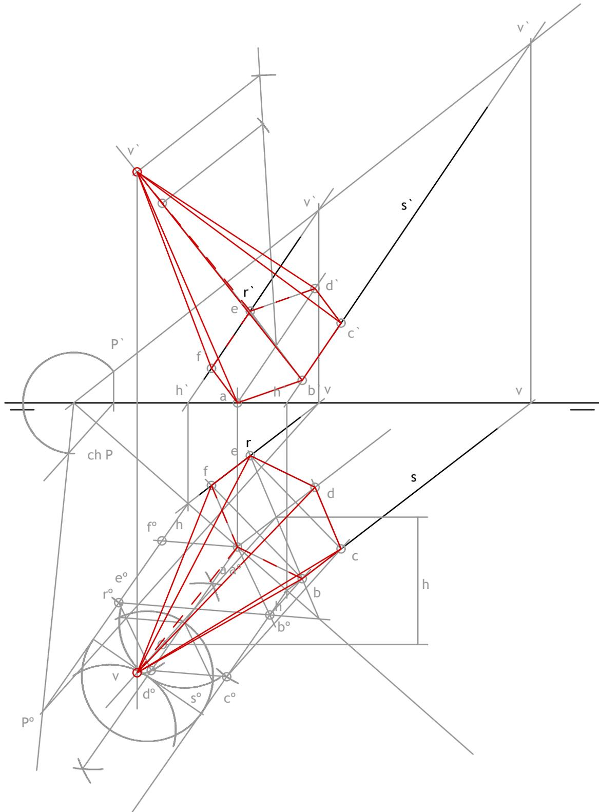
Dado el segmento sobre el plano horizontal de proyección de un cuadrado ABCD contenido en el plano P, se pide:
