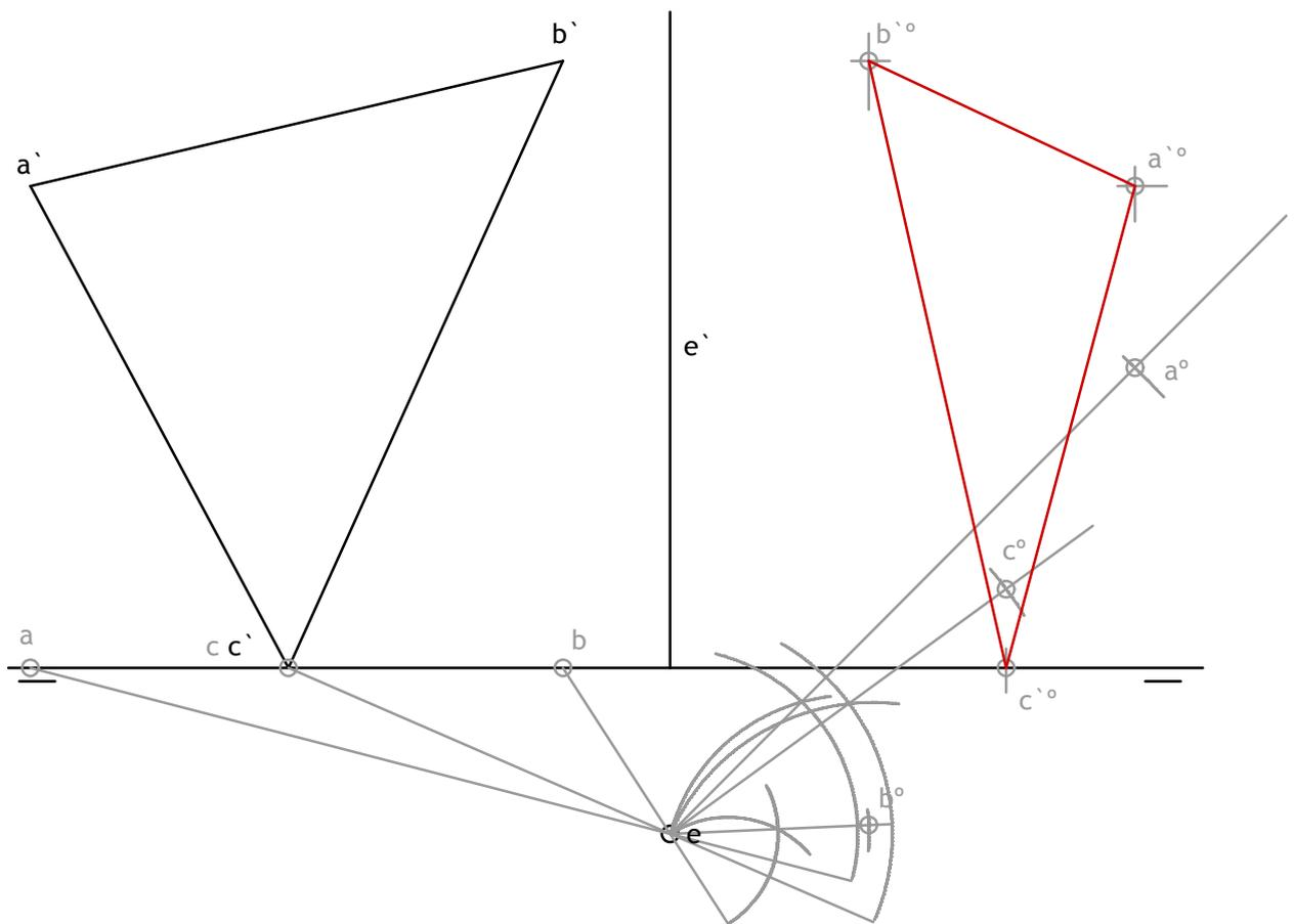
Determinar las nuevas proyecciones del cuerpo representado al efectuar un giro de  $180^\circ$  alrededor del eje vertical E ( $e'e$ ).
