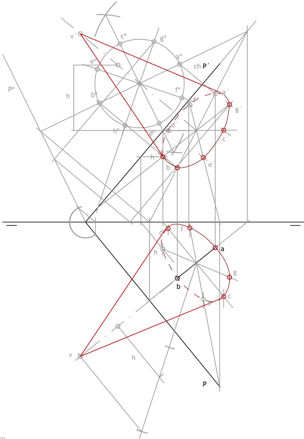
El segmento de perfil AB, dado por sus proyecciones, pertenece a una recta de máxima pendiente de un plano P. Dicho segmento AB es la diagonal de un hexágono regular situado en el plano P. Se pide:
