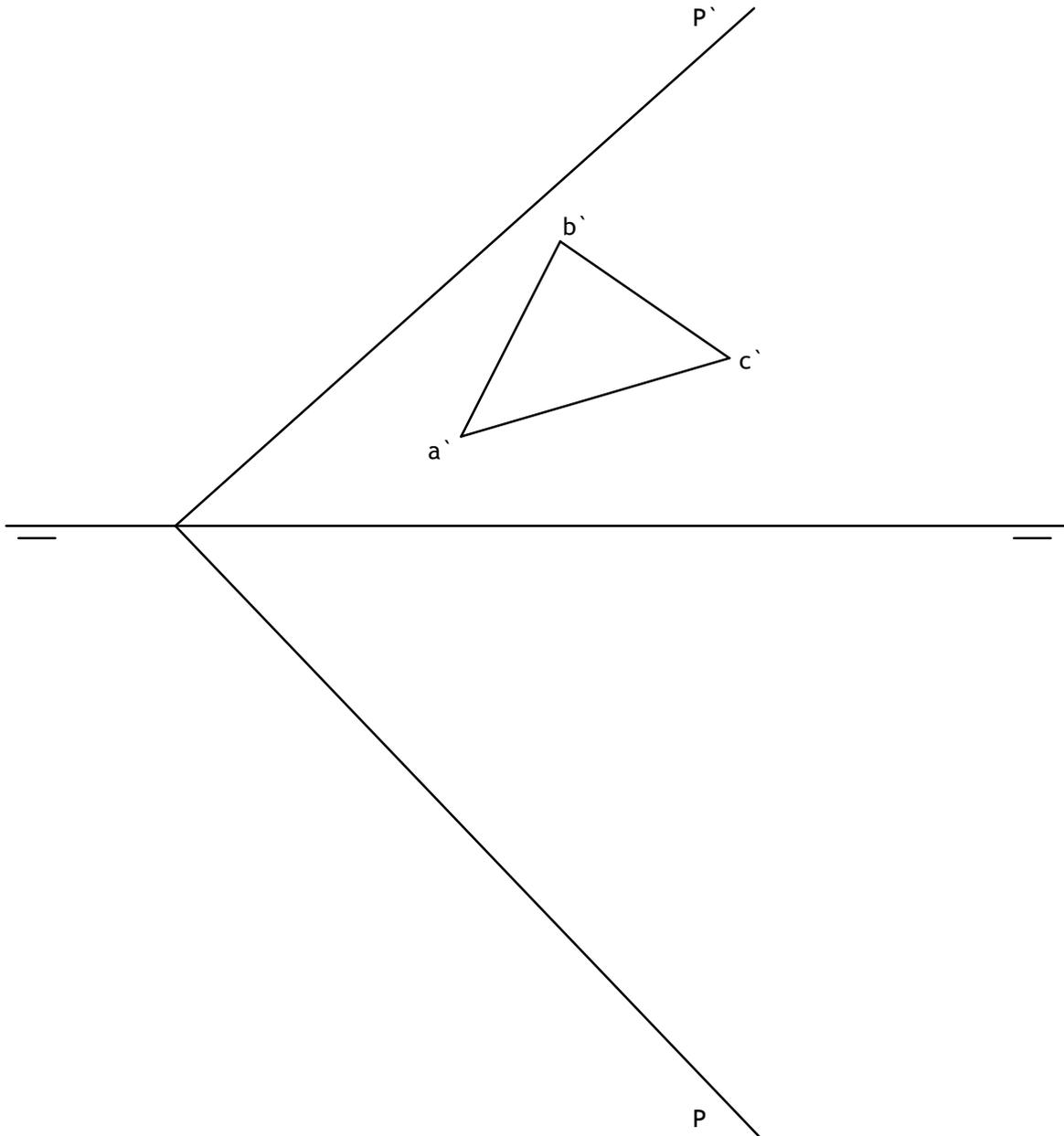
Conocida la proyección vertical del triángulo ABC contenido en el plano P, se pide:
