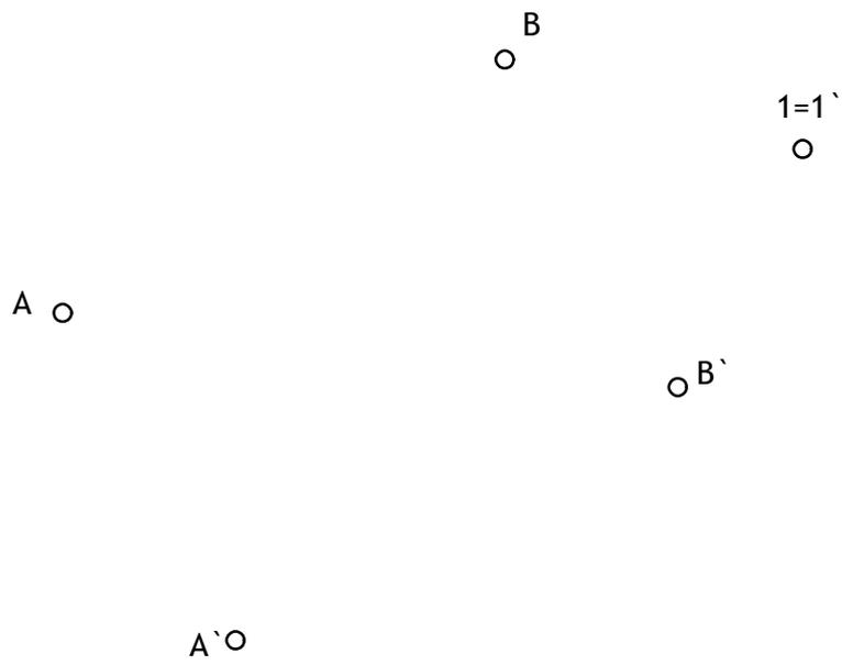
De una homología afín en el plano del dibujo, se conocen: Los puntos A y B y sus afines A'B' y el punto  $1=1'$  del eje de dicha afinidad.
