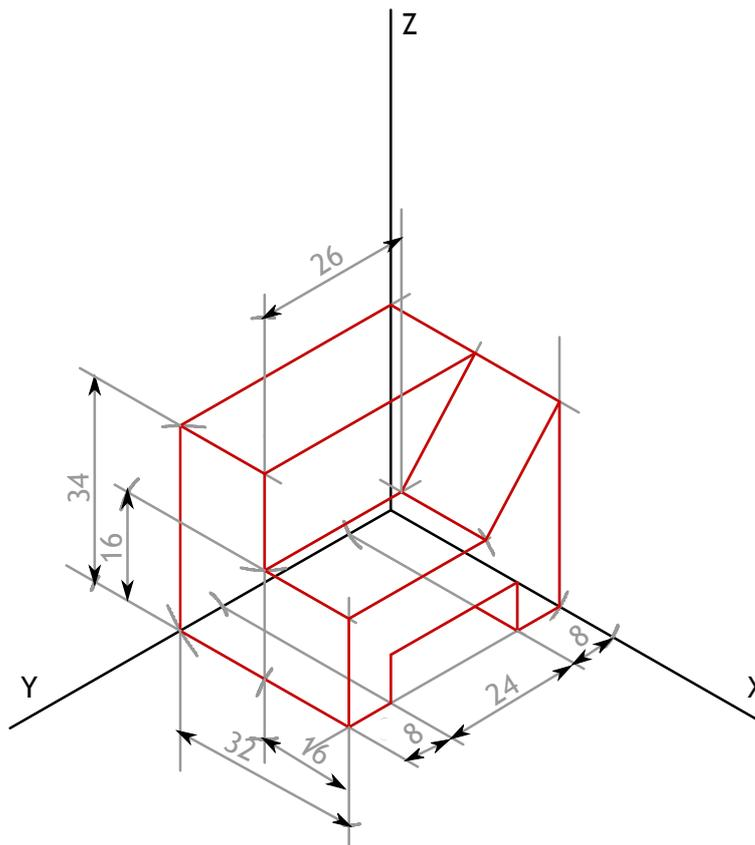
Dado un sólido por su alzado, planta y perfil en Sistema Europeo (primer diedro) y escala E=1:1, se pide realizar su perspectiva axonométrica a escala E= 3:2, considerando los ejes dados, y sabiendo que el coeficiente de reducción que hay que aplicar es de 0,816.
