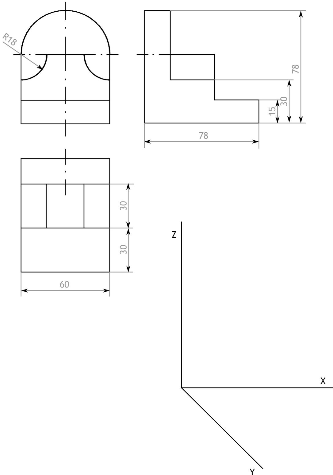
Dada la pieza definida por su alzado, planta y perfil izquierdo, según el método de representación del primer diédrico de proyección, se pide:
