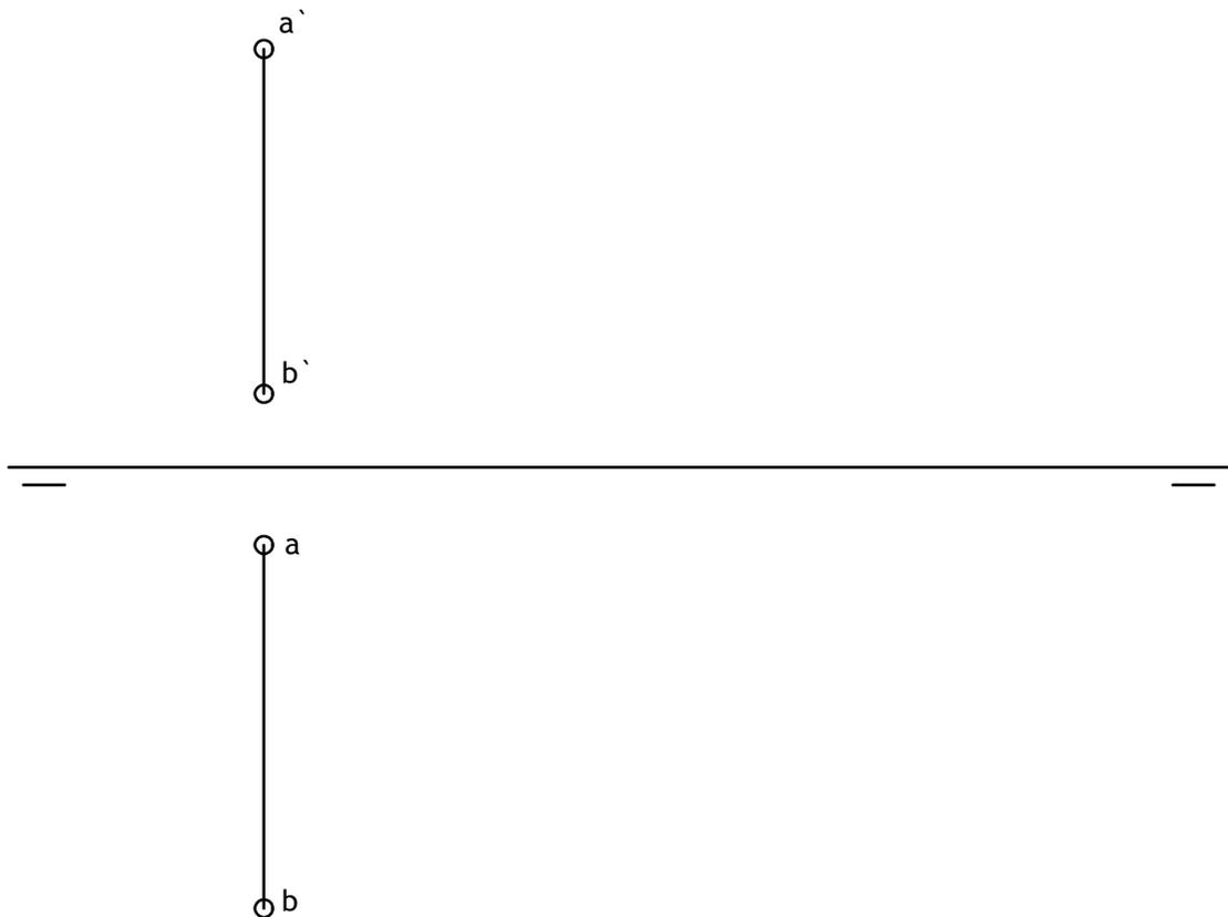
El segmento de perfil AB, dado por sus proyecciones, pertenece a una recta de máxima pendiente de un plano P. Dicho segmento AB es la diagonal de un hexágono regular situado en el plano P. Se pide:
