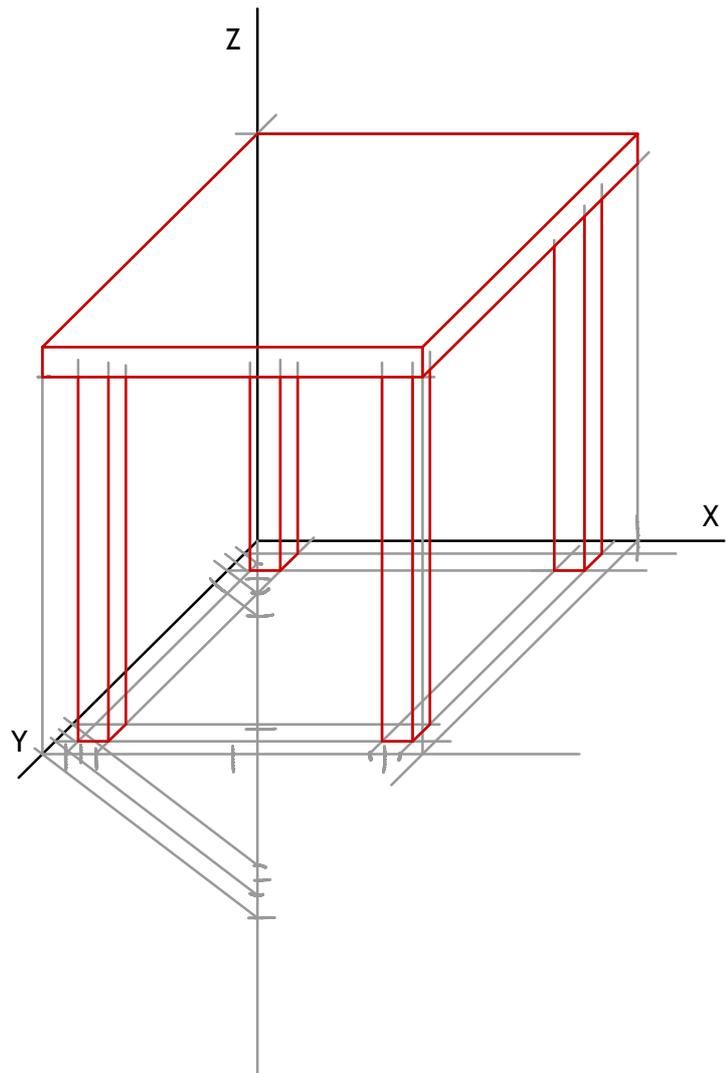
Dibuja a escala 1:1 la perspectiva caballera del sólido definido por sus vistas alzado, planta y perfil izquierdo en el sistema de proyección del primer diedro, siendo el coeficiente de reducción a aplicar en la dirección OX de 3/4.
