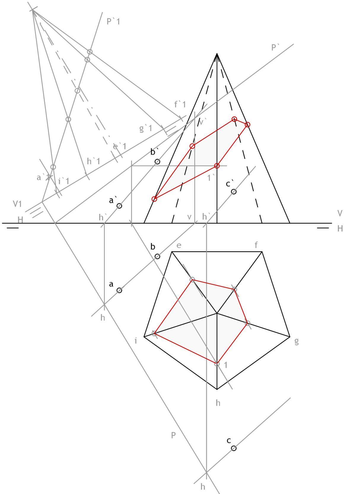
Un cono de revolución de 6 cm de altura tiene por base un círculo, situado en el plano horizontal de proyección, de centro el punto O (o' o) y radio 4 cm.
