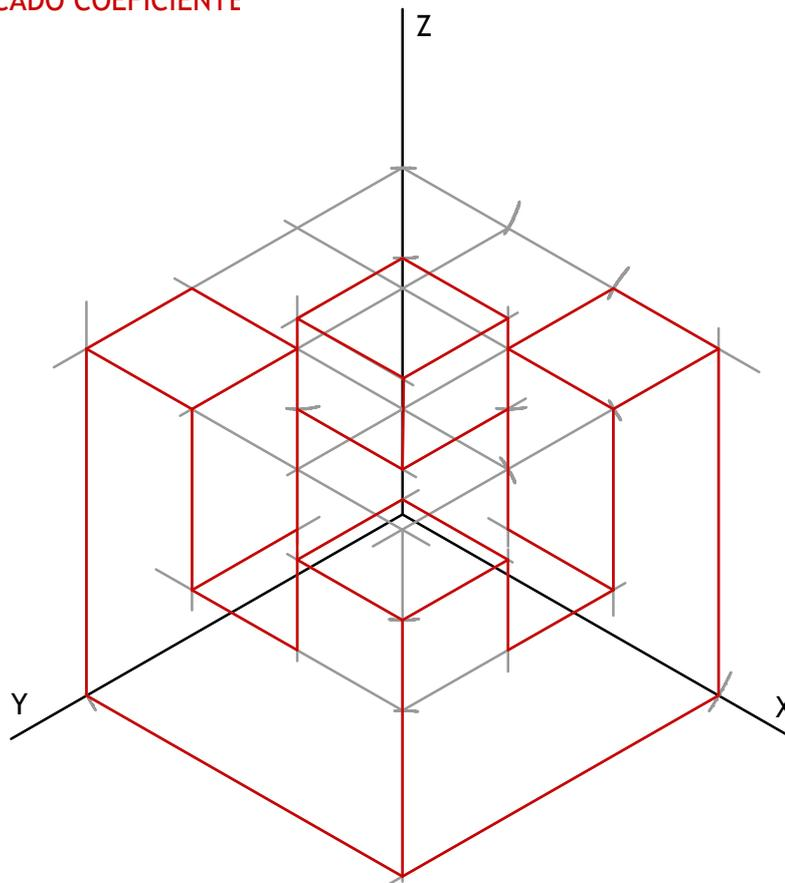
Dadas las vistas de la figura en Sistema Europeo (primer diedro), dibujar la perspectiva isométrica de la misma, utilizando coeficiente de reducción, partiendo de los ejes coordenados representados.
