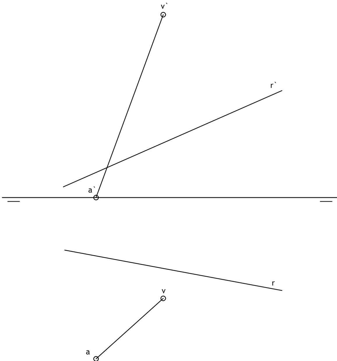
Dadas las proyecciones de la recta R y del segmento VA, arista lateral de una pirámide regular, cuya base es un hexágono regular situado en el plano horizontal de proyección, se pide:
