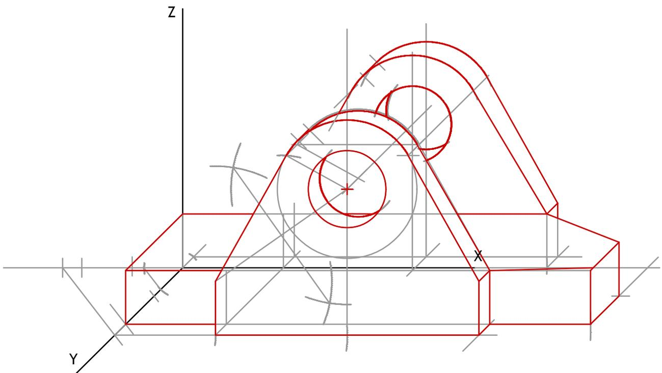
Dibujar a escala 2:3 la perspectiva caballera de la pieza definida por su alzado y perfil derecho a escala 1:3, según el método del primer diedro, sabiendo que el coeficiente de reducción es 0.8.
