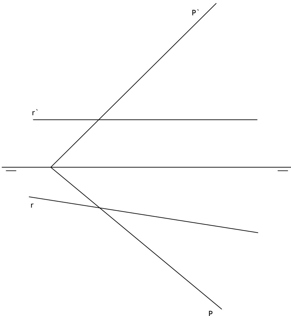
Dadas las proyecciones de la recta horizontal R ( $r'$ ) y las trazas del plano P ( $P'$ ), se pide:
