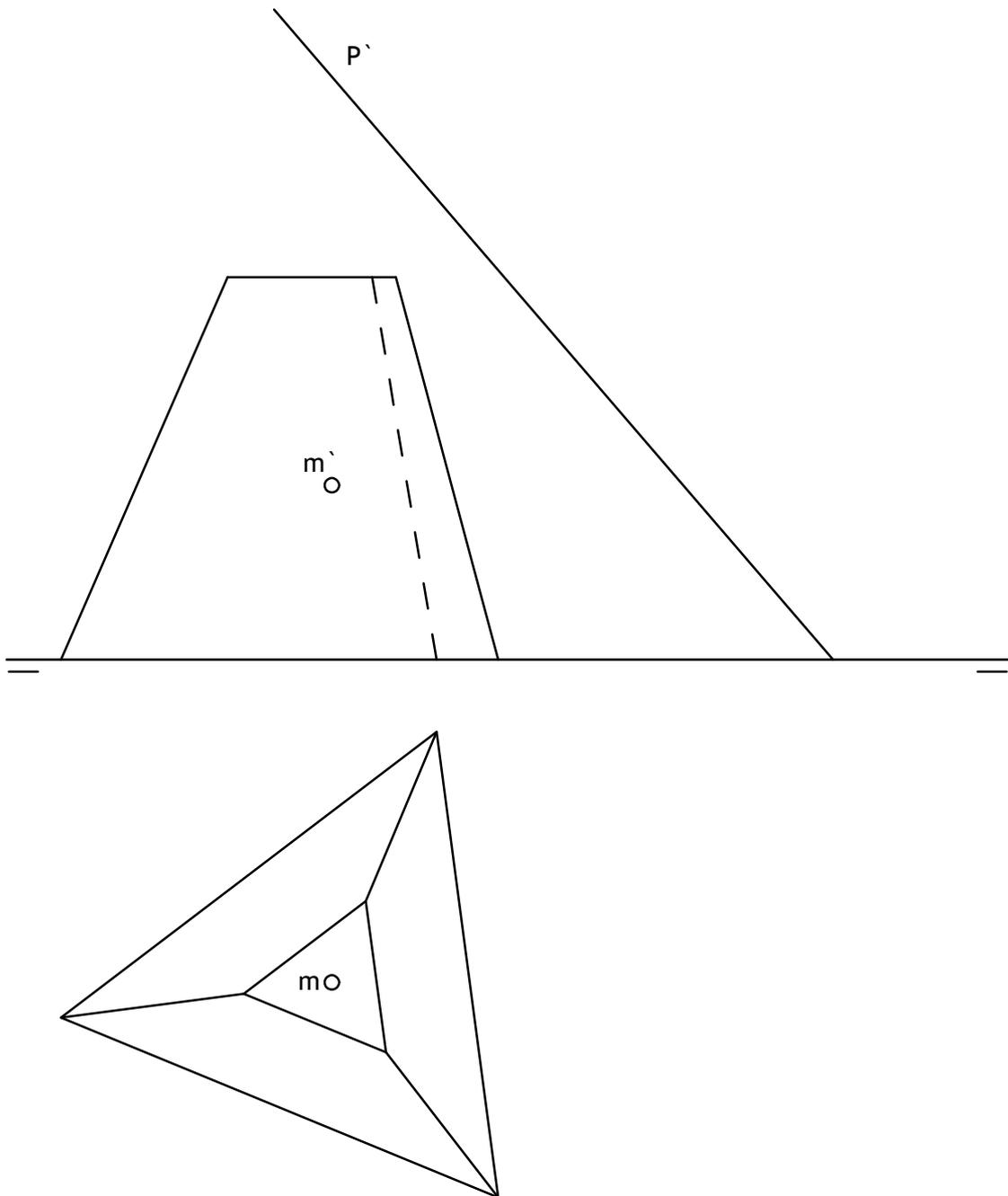
Se dan las proyecciones de un tronco de pirámide, la traza vertical  $P'$  de un plano  $P$ , y las proyecciones  $m$   $m'$  del punto  $M$  que pertenece al plano  $P$ . Se solicita:
