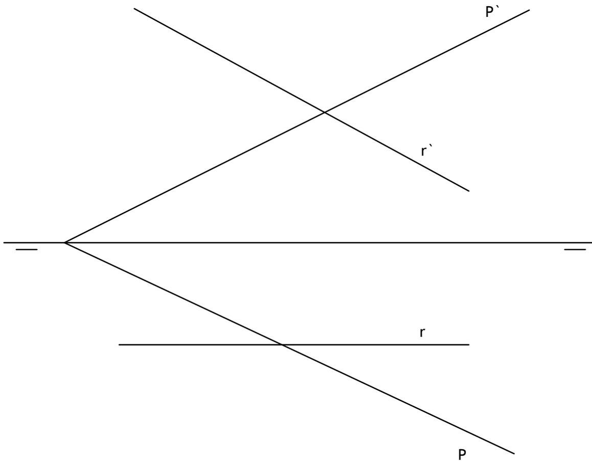
Se definen el plano P ( $P'P$ ) y la recta frontal R ( $r'r$ ) por sus trazas y proyecciones respectivamente, se pide:
