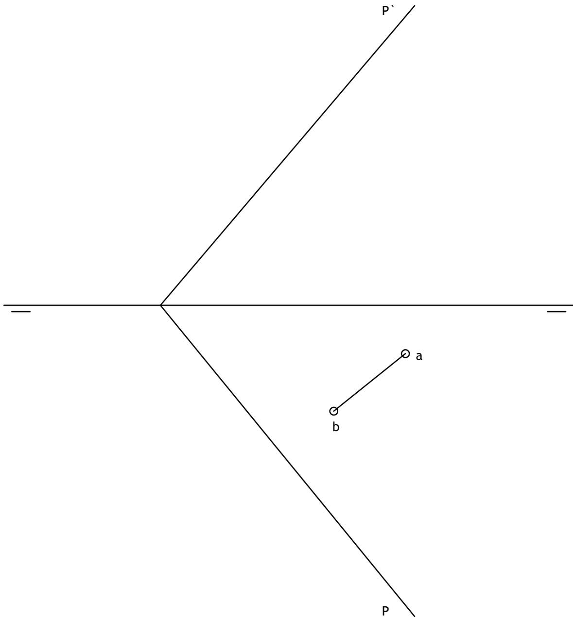
Conocidas las trazas del plano P y la proyección horizontal de un segmento AB contenido en dicho plano, se pide:
