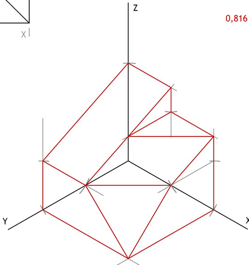
Definido el sólido por su alzado, planta y perfil, en Sistema Europeo (primer diedro), se pide dibujar su perspectiva axonométrica a escala  $E= 1,5:1$  considerando los ejes dados, y sabiendo que el coeficiente de reducción que hay que aplicar es de 0,816.
