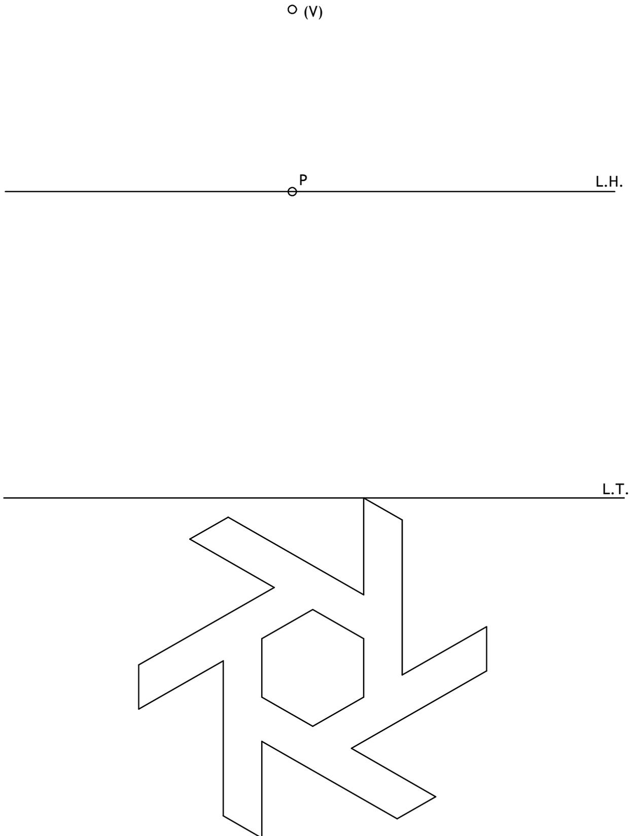
Definido el sistema cónico por la línea de tierra L.T., la línea de horizonte L.H., el punto principal P y el abatimiento sobre el plano del cuadro del punto de vista (V), se pide:
