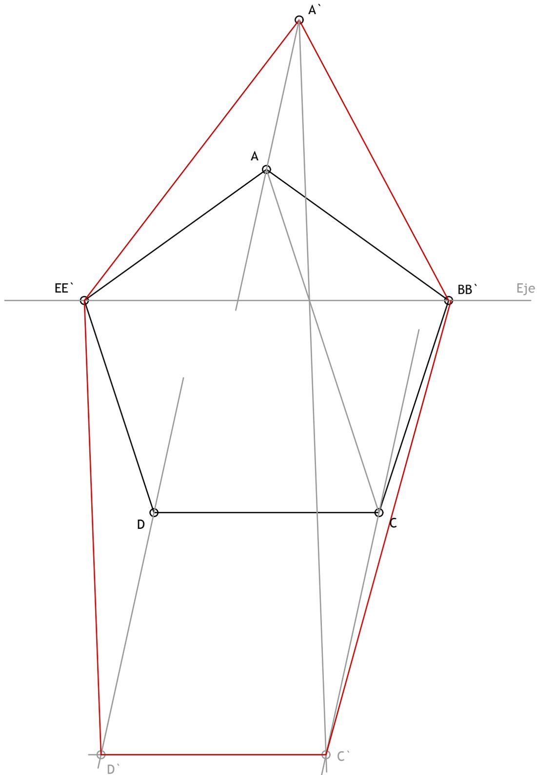
Definida una afinidad ortogonal por el eje E y el par de puntos afines AA', se pide:
