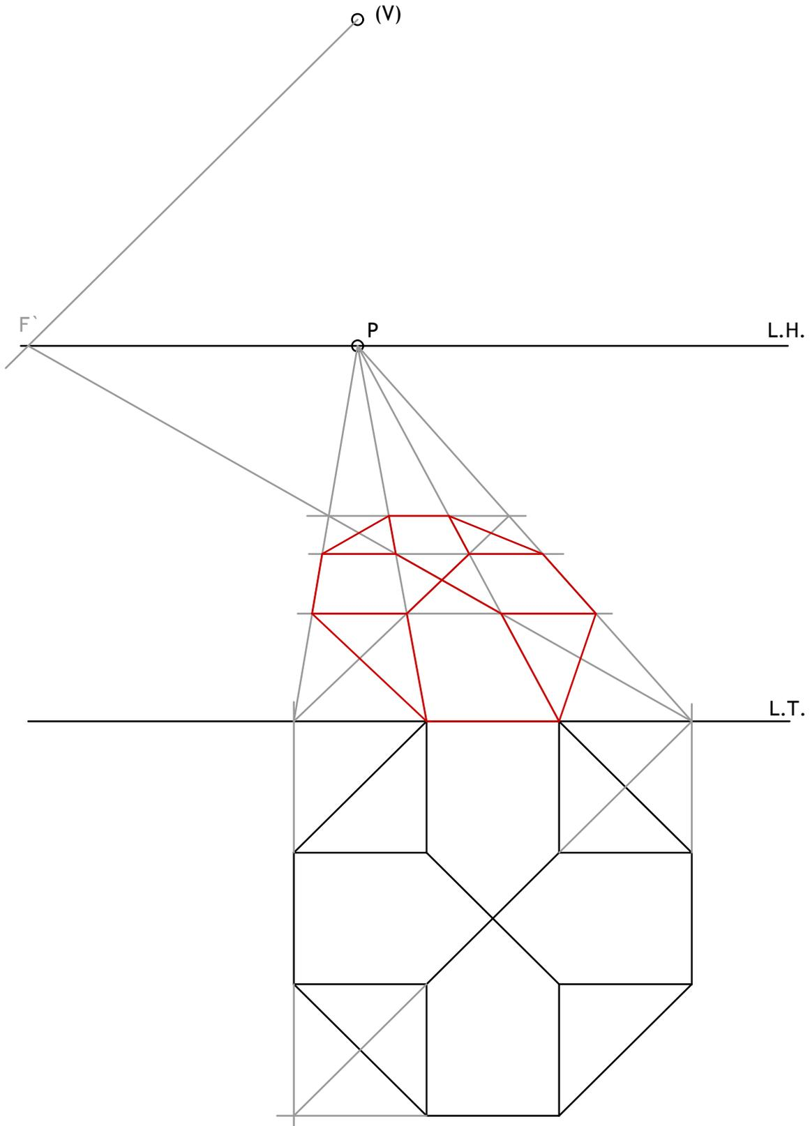
Definido el sistema cónico por la línea de tierra L.T., la línea de horizonte L.H., el punto principal P y el abatimiento sobre el plano del cuadro del punto de vista (V), se pide:
