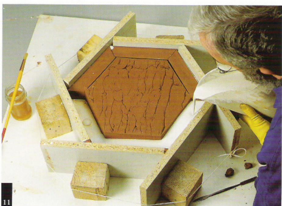
5. Dispongo el encofrado con seis tablas melaminadas, que sujeto con seis tacos de madera y ato con un cordel. Después, muevo los tacos hacia el centro de las tablas, haciendo que el cordel quede tenso y sujete el encofrado. También coloco rollos de arcilla en las uniones interiores de las tablas, para que el yeso no entre en ellas, así el encofrado queda sellado. Luego repito el proceso por el exterior, para impedir que el yeso pueda dispersarse.
