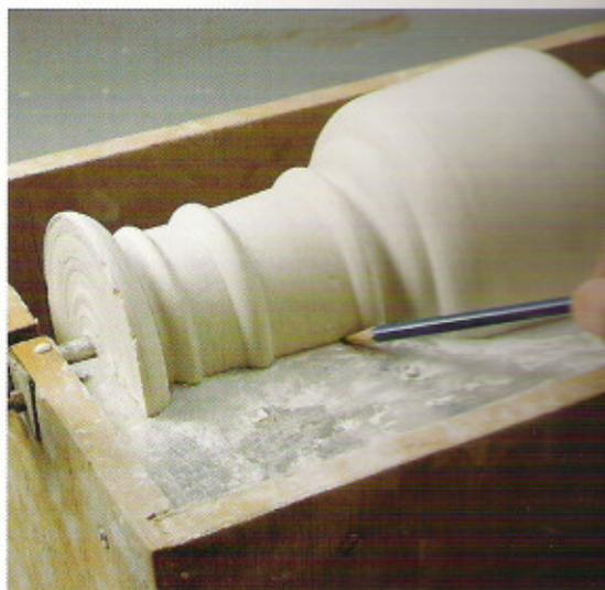
15. Aspecto de la pieza terminada. Esta pieza, además del volumen torneado, necesita cuatro planchas de diferentes medidas que situaré en las dos bases. Para realizarlas, utilizo cuatro listones melaminados y un encofrado móvil (con ángulos metálicos en uno de sus extremos). Con la escuadra, compruebo la perpendicularidad de los listones.
