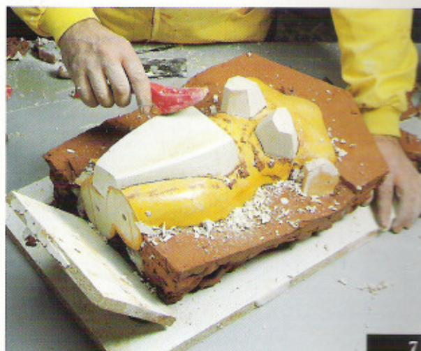
8. Limpio las partículas de yeso de la partición. Practico las llaves semiesféricas y modelo dos planas en una plancha de 8 mm de grosor. Con las tablas cierro el encofrado, pero en la base coloco una plancha de arcilla de 1 cm de grosor que contornea la forma.
