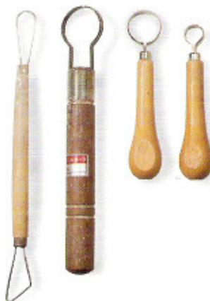
diferentes formas y están compuestos por un mango de madera, en cuyos extremos hay un alambre o un fleje metálico doblado en una forma
