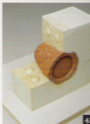
41. Aspecto de la primera parte del molde terminada, con la segunda partición preparada y encofrado con dos tablas sujetas con un gato, antes de cerrar el molde con la tabla delantera.
