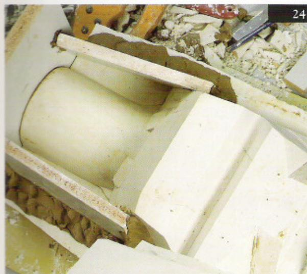
26. Vuelvo a preparar un encofrado más grande que sello por el interior con rollos de pasta, para que el yeso no se filtre. Antes de atarlas con el cordel, sujeto las tablas con cinta adhesiva, para que se mantengan unidas. Preparo el yeso y empiezo a verterlo en el interior del encofrado, que llenaré en tres veces.
