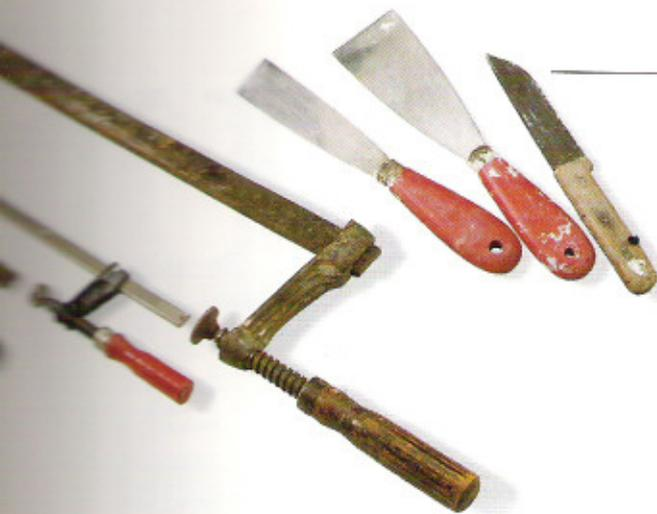
**Guantes.** También llamados prensas de mano. Están formados por una barra de acero de forma rectangular, en uno de cuyos extremos hay un brazo fijo y en el otro uno móvil con un tornillo roscado, donde se aprietan las piezas que deben quedar sujetas. Es esencial para sostener las tablas de los encofrados en moldes de forma regular (prismática o cúbica).
